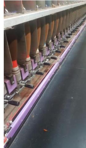
Figura 2 – Particolare fune d'emergenza su macchina a fuso cavo Gigliotti Fantafilo ST1
