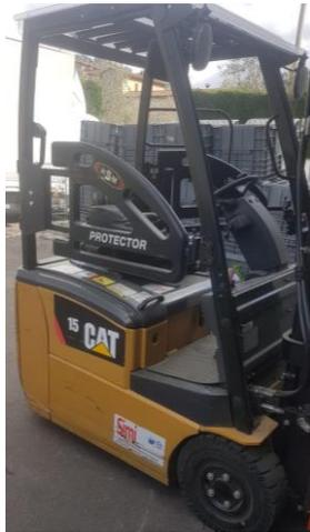
Figura 1 – Carrello elevatore con sistema trattenuta del conducente Protector Mod.HSP-E
