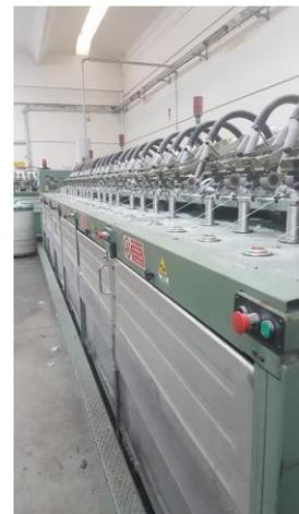
Figura 4 – Pulsanti di emergenza lungo tutto il fronte del banco a fusi NSC BM 12
